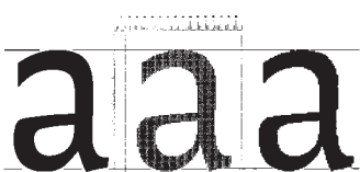
Comme pour les typographies d'annuaires, en photocomposition, Mandel a prédigitalisé les caractères du Messidor. D'après ses originaux, tracés en traits continus, il a interprété les contours (selon la matrice de définition de flashage, tubes cathodiques ou laser) pour maîtriser parfaitement la transformation en bitmap des dessins.
